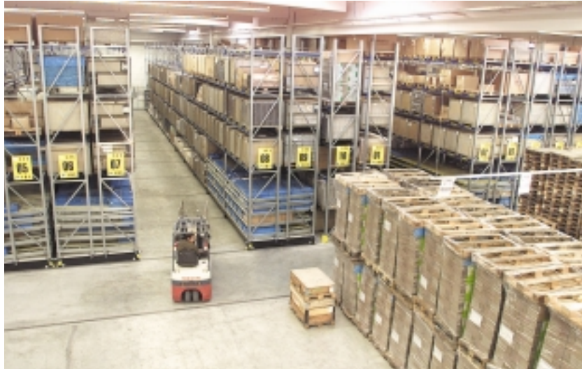
Foto R.5.2 Sehr ungewöhnlich, sehr schnell, sehr umschlagstark: 6 Verschiebeanlagen à 4 Fahrwagen mit Durchlaufregalen! Technik: SSI Schäfer
